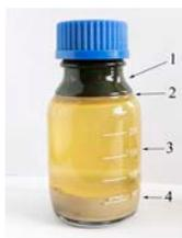
1 – нефть, 2 – эмульсия нефть - вода, где протекает реакция поликоординации ВНК с ионами кальция, магния и др., 3 – вода, добываемая попутно с нефтью, 4 – осадок координационных полимеров ВНК
