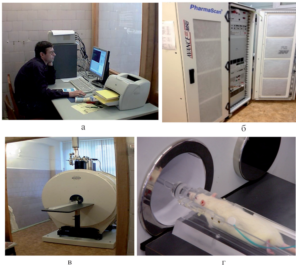
Рис. 1. Магнитно-резонансный томограф “PharmaScan US 70/16” (Фармаскан); выпущен фирмой Bruker (Германия); состоит из сверхпроводящего магнита мощностью 7 Тесла и частотой процессора 300 MHz, операционного модуля “Avance”, рабочей станции и программного обеспечения ParaVision 5.1 . а – консоль, б – операционный модуль, в – томограф, г – животное под анестезией
