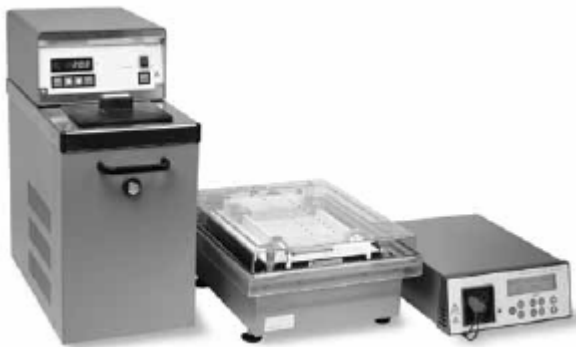
Рис.13. Прибор для проведения двумерного электрофореза Amersham Bioscience (циркуляционный термостат с охлаждением, камера для изоэлектрофокусирования и электрофореза в ПААГ, высоковольтный источник питания)
